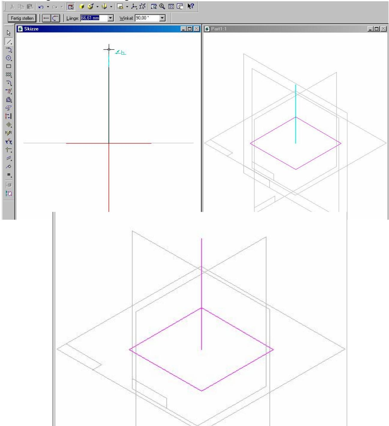
Anschließend die Pyramide mit der „Übergangsausprägung“ erstellen.
