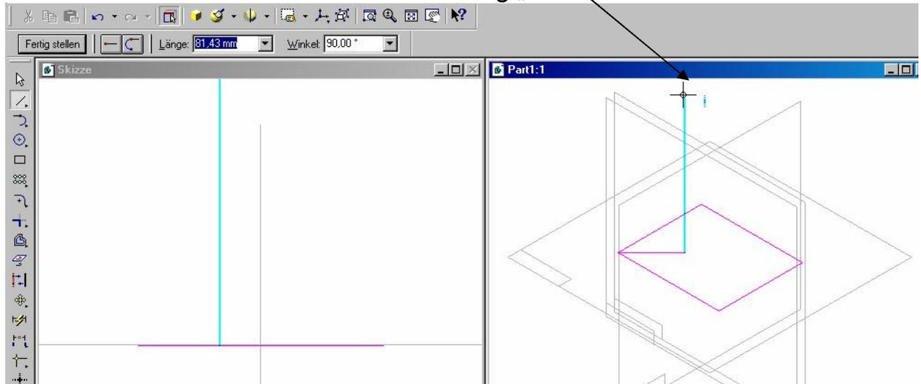
7. Höhe der Pyramide mit „Smart Dimension“ (80) bemaßen. Anschließend 2x „Fertig stellen“ und das „Part-Fenster“ maximieren.
