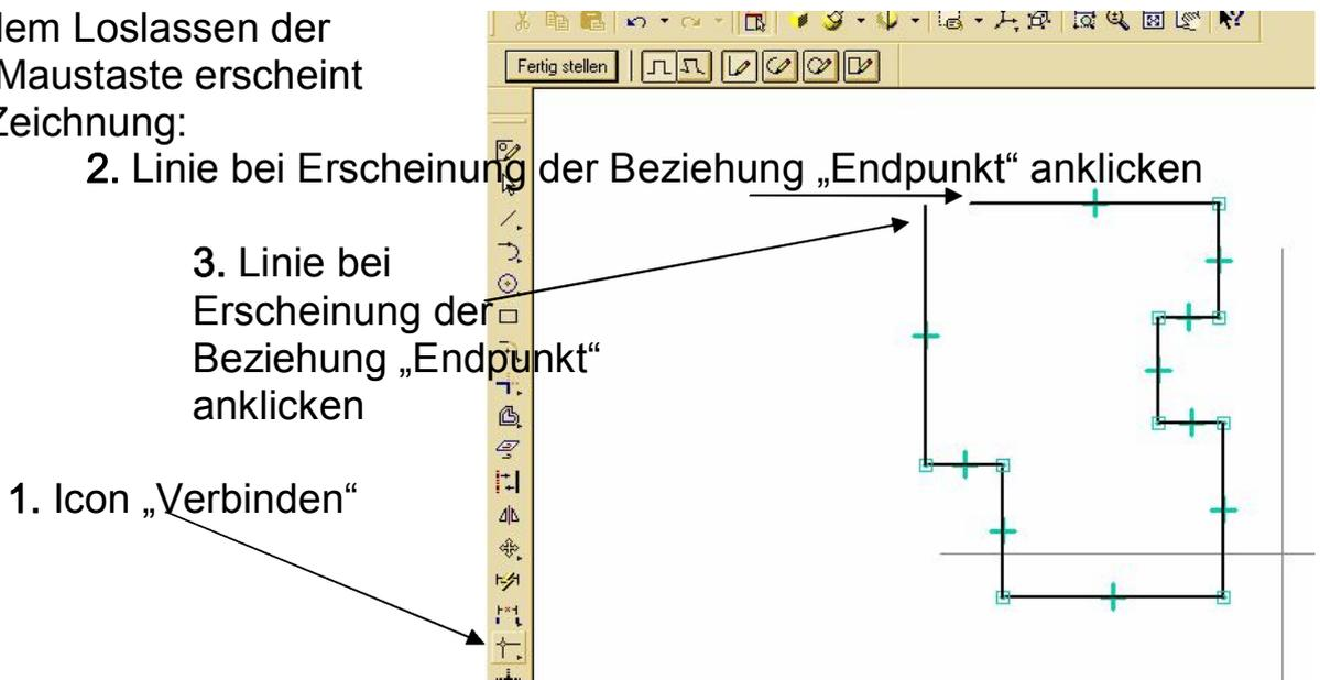
Durch das „Verbinden“ der Endpunkte der Linien wird das Profil geschlossen.
