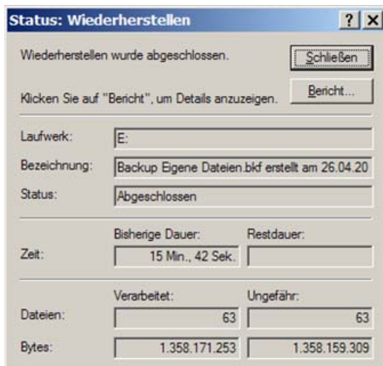
Abbildung – Status: Wiederherstellen: Die Wiederherstellung ist beendet, optional kann ein Bericht angezeigt werden.
