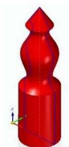
4. Die erstellten Spielfiguren und Zählsteine werden jetzt in dem CAM-Programm Cura für den 3-D-Druck auf das Druckbett positioniert und einem PLA-Filament zugewiesen. Jetzt kann der Druck auf eine SD-Speicherkarte generiert werden. Der 3-D-Drucker kann diese generierte Datei einlesen und mit dem Drucken beginnen.
